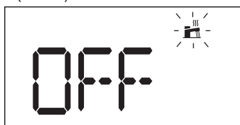
Afb.11 Bedrijf in de sanitair-watermodus (SWW) uitschakelen
